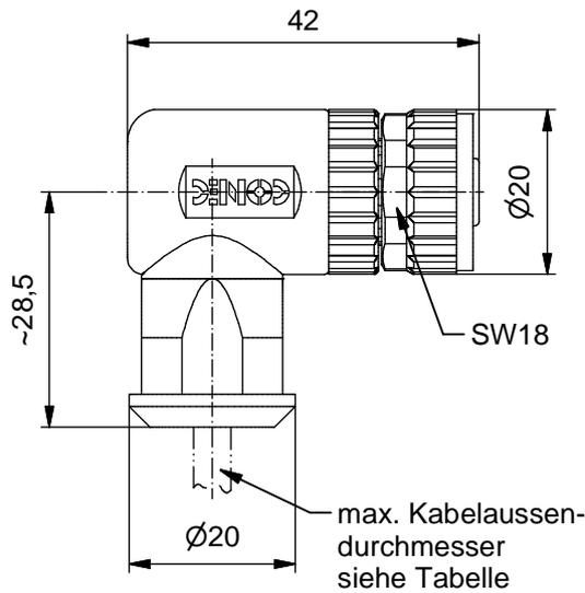
Gehäuse kann um 90° versetzt montiert werden
